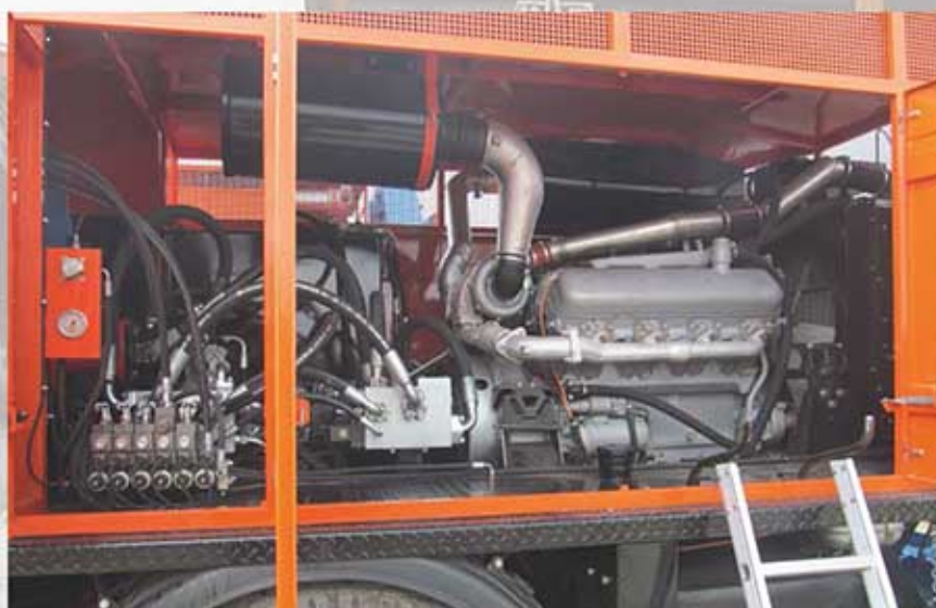
Силовая установка ЯМЗ-7511, 400 л.с.
